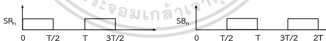
(ก) ชุดสัญญาณควบคุมอุปกรณ์สวิตช์กำลัง SR_n (ข) ชุดสัญญาณควบคุมอุปกรณ์สวิตช์กำลัง SB_n
