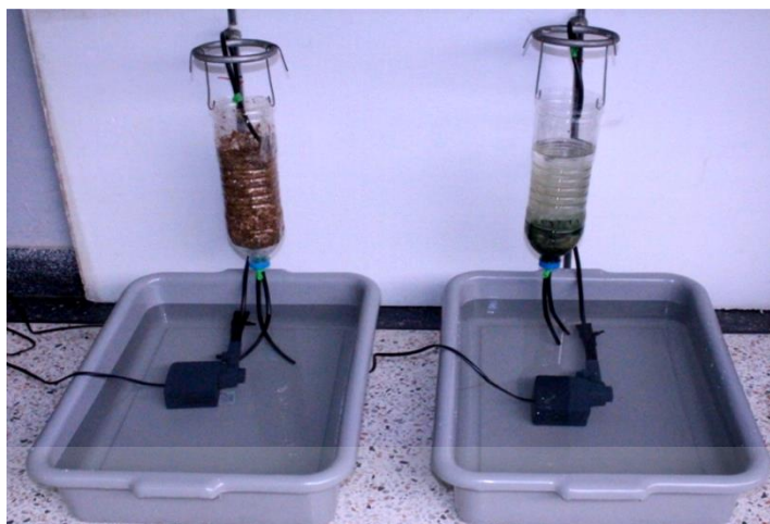
ภาพที่ 3.1 ระบบหมุนเวียนสารละลายธาตุอาหารที่ใช้ในการทดลองเบื้องต้น
