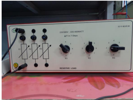
รูปที่ 3.4 ตัวต้านทานปรับค่าได้สำหรับสร้างแรงดันไม่สมดุล
