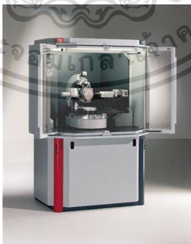
รูปที่ 3.5 เครื่องทดสอบการเลี้ยวเบนของรังสีเอ็กซ์ (X-ray diffractometer; XRD) [26]
