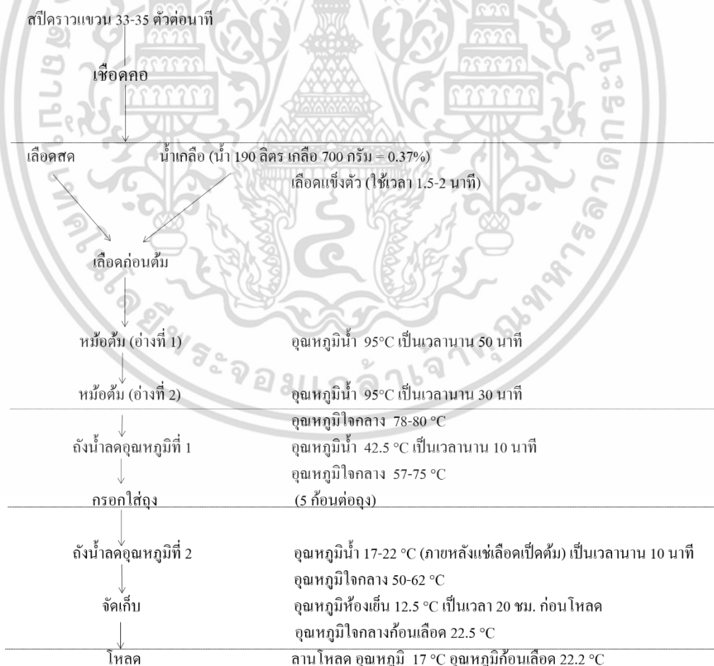
ภาพที่ 2.1 ขั้นตอนกระบวนการผลิตเลือดเป็ดต้มของโรงงานฆ่าเป็ดในจังหวัดฉะเชิงเทรา
