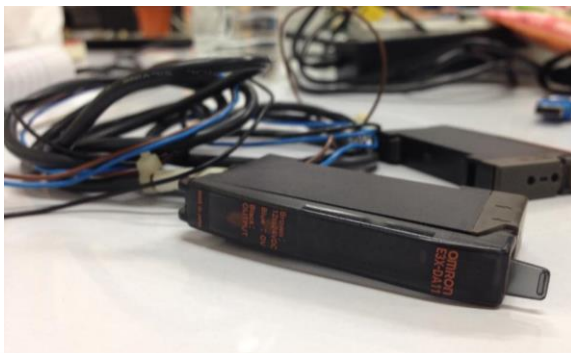
รูปที่ 3.5 เซนเซอร์แสง รุ่น E3X-DA11
