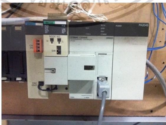
รูปที่ 3.4 พีแอลซี (PLC) Omron รุ่น C200HX
