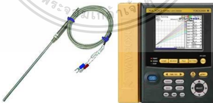
รูปที่ 5.25 thermocouple type K และหน่วยแสดงผล YOKOGAWA XL 100
