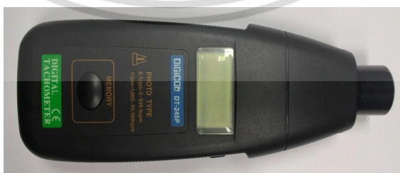
รูปที่ 5.30 เครื่องวัดความเร็วรอบ (tachometer) ยี่ห้อ Digicon รุ่น DT-245P
