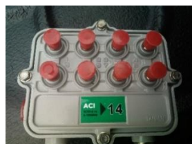
รูปที่ 2.19 อุปกรณ์แทปแบบ 8 ทาง (ด้านซ้าย) และ สัญลักษณ์อุปกรณ์แทปแบบ 8 ทาง (ด้านขวา)
