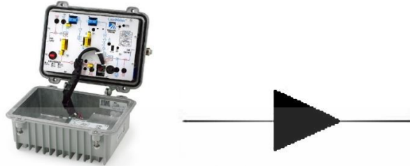
รูปที่ 2.15 อุปกรณ์ไลแอ็คเทนเดอร์ (ด้านซ้าย) และ สัญลักษณ์อุปกรณ์ไลแอ็คเทนเดอร์ (ด้านขวา)
