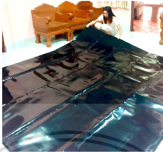
รูปที่ 3.4 การตัดและติดกาวยางพลาสติกพีวีซี
