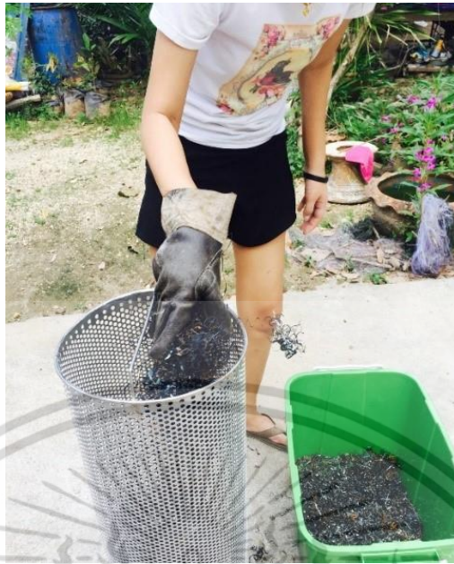
รูปที่ 3.17 การใส่ขี้กลิ้งเหล็กลงในตะแกรงของตัวกรองที่ 1
