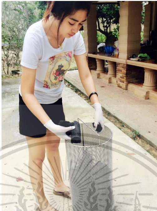
รูปที่ 3.19 การใส่ถ่านลงในตะแกรงของตัวกรองที่ 3
