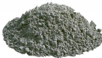
รูปที่ 3.2 ตัวเร่งปฏิกิริยาเอพซีซีใช้แล้วก่อนการปรับสภาพพื้นผิวด้วยความร้อน
