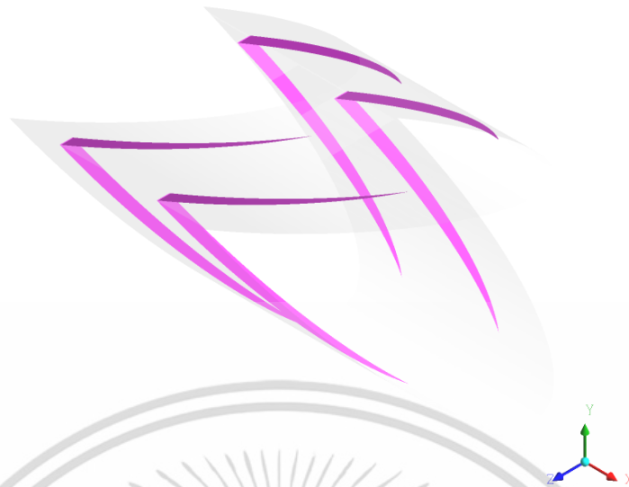
รูปที่ 5.29 ท่อกลมที่ใส่แผ่นบางติดปีกคู่เปิดด้านหน้าและด้านหลัง
