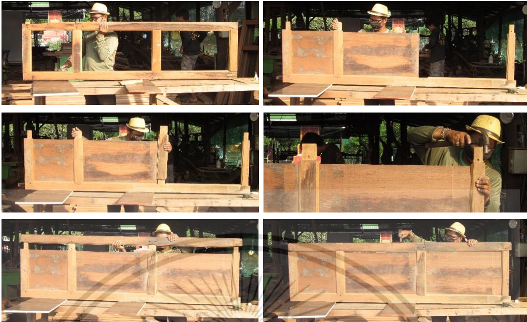
ถอดกรอบบานที่ปรับขนาดแล้วออกเพื่อประกอบลูกฟักโดยใช้ค้อนหงอนตอกให้เดือยลงร่อง
