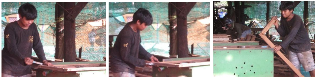
ใช้สิ่วและค้อนหงอนงัดกรอบบานให้หลุดออกจากกัน
