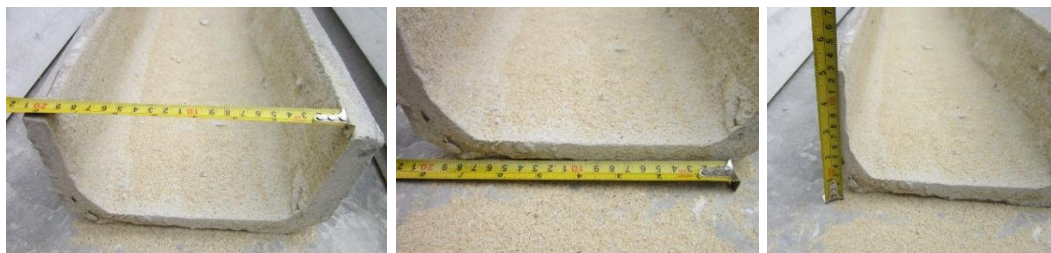
หน้าตัด ขนาดและระยะของบัวขอบผนังด้านหน้า
