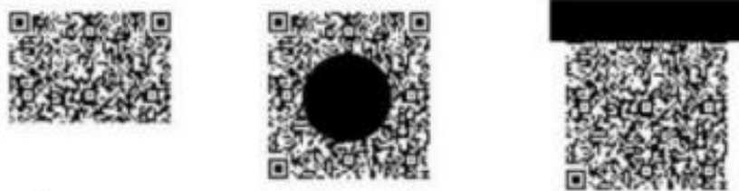
รูปที่ 2.11 ลักษณะการลบหรือถูกขีดเขียนบนคิวอาร์โค้ด (QR code)
