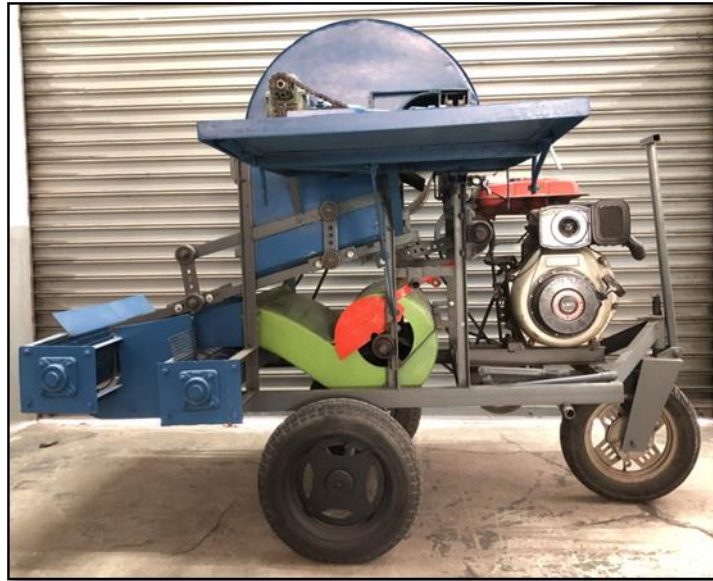
รูปที่ 3.10 เครื่องผลิตฝักถั่วลิสงแบบไหลตามแนวแกน
