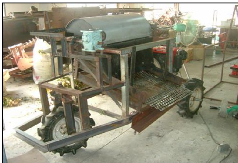
รูปที่ 3.3 แสดงเครื่องปลิดฝักถั่วลิสงต้นแบบ
