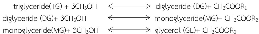
รูปที่ 2.3 กลไกปฏิกิริยาทรานเอสเทอร์ฟิเคชันระหว่างน้ำมันพืชกับแอลกอฮอล์
