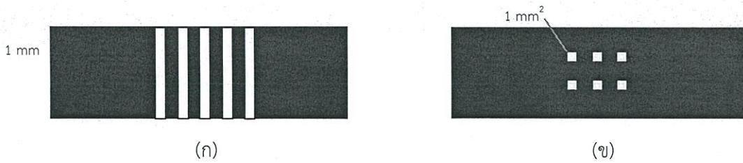
รูปที่ 3.5 ลักษณะหน้ากากสำหรับระเหยอลูมิเนียม (แถบดำหมายถึงบริเวณที่เป็นหน้ากาก) (ก) บนฐานรองรับพลาสติก (ข) บนฐานรองรับกระจก
