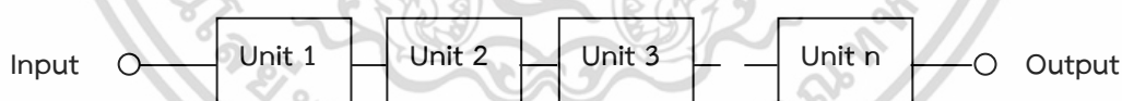
รูปที่ 2.2 แบบจำลองระบบที่ต่ออนุกรมกันจำนวน n หน่วย
