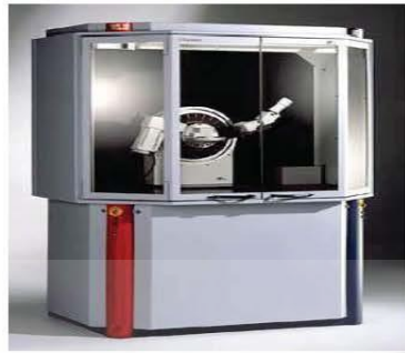
รูปที่ 3 ภาพถ่ายเครื่องเอกซเรย์ดิฟแฟรคโทรมิเตอร์ ชื่อ Bruker รุ่น D8 Advance
