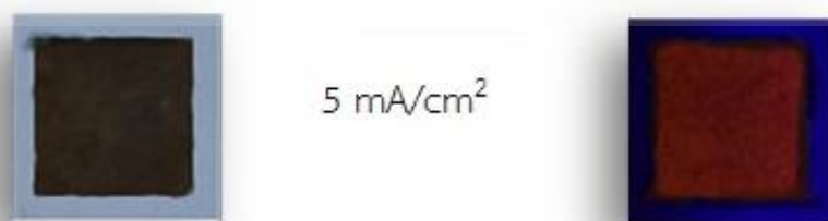
รูปที่ 5.7 ชั้นพอร์สซิลิคอนที่สร้างโดยความหนาแน่นกระแสไฟฟ้าในการแอนโนไดซ์เซชันต่างกัน
