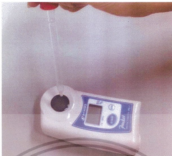
ภาพที่ 3.8 การวัดปริมาณของแข็งที่ละลายน้ำได้
