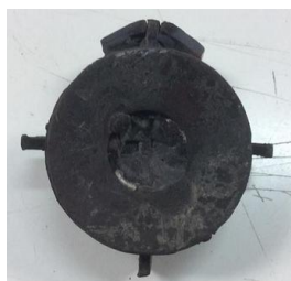
(ก) แผ่นขวางกั้นช่องการไหลที่ใช้ทดลองจริง
