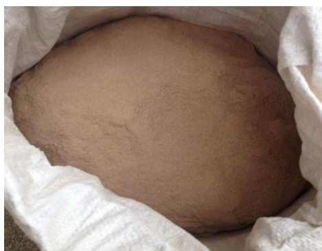
รูปที่ 3.2 เชื้อเพลิงชีวมวลฝุ่นที่ผ่านการบด
