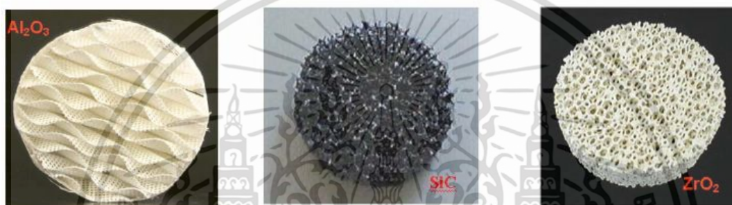
รูปที่ 3.7 แสดงวัสดุพอรุนชนิดเซรามิกชนิดต่างๆ
