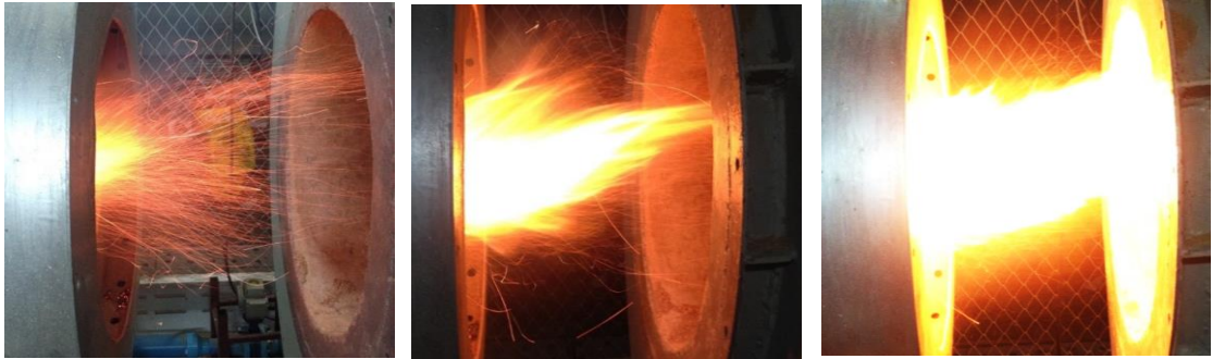
รูปที่ 1.2 เปรียบเทียบประสิทธิภาพการเผาไหม้ของชีวมวลผงที่ผ่านตะแกรง 1.5, 1 และ 0.5 มิลลิเมตร
