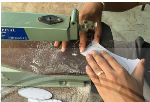
รูปที่ 4.10 ขั้นตอนการตัดแผ่นอะครีลิคตามแบบ
