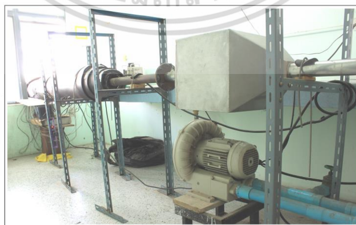
รูปที่ 4.3 ชุดทดลองเครื่องแลกเปลี่ยนความร้อนชนิดท่อหน้าตัดกลม
