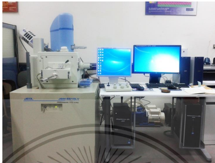
รูปที่ 3.11 กล้องจุลทรรศน์อิเล็กตรอนแบบส่องกราด (SEM) ยี่ห้อ JEOL รุ่น JSM-6610LV
