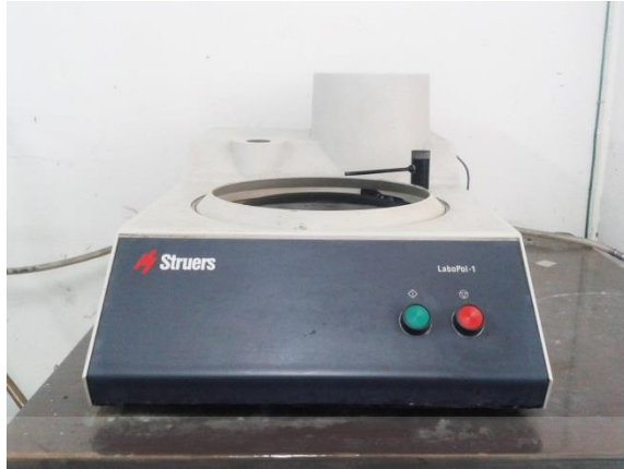
รูปที่ 3.9 เครื่องขัดชิ้นงานทดลองยี่ห้อ Struers รุ่น LaboPol-1
