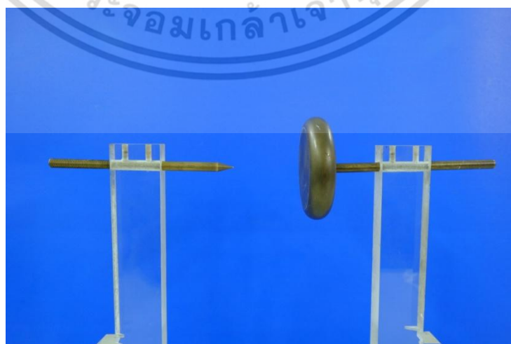
รูปที่ 3.10 แหล่งกำเนิดดิสชาร์จบางส่วนแบบโคโรนาดิสชาร์จด้านแรงต่ำ
