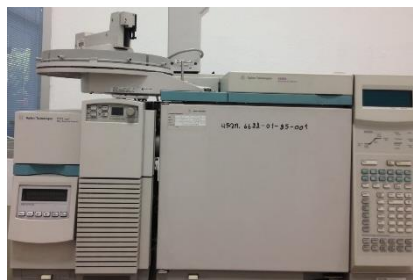
ภาพที่ 3.1 เครื่อง Gas Chromatography Mass Spectrometer (GC-MS) (GC: Agilent Technologies; 6890N Network GC System) และ (MS: Agilent Technologies; 5973 inert Mass Selective Detector)
