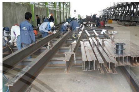
รูปภาพที่ 4.8 การตรวจสอบขนาดและระยะต่างๆ ของชิ้นงานให้เป็นไปตาม Shop drawing
