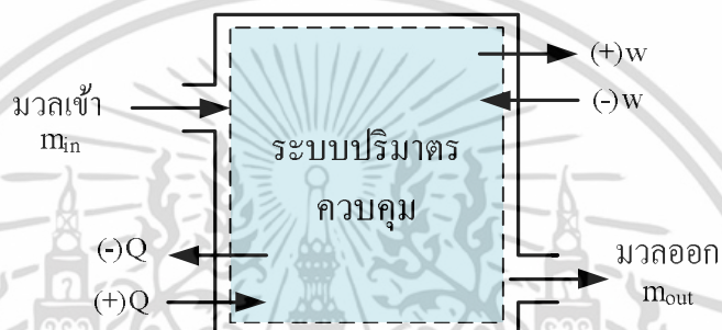
รูปที่ 2.2 การเปลี่ยนแปลงพลังงานภายในระบบเนื่องจากการไหลเข้า-ออกของมวล [6]
