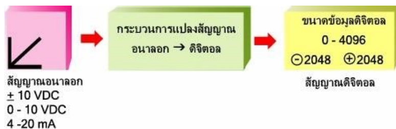
รูปที่ 2.17 ไตอะแกรมการส่งข้อมูลอนาลอกให้ PLC [4]
