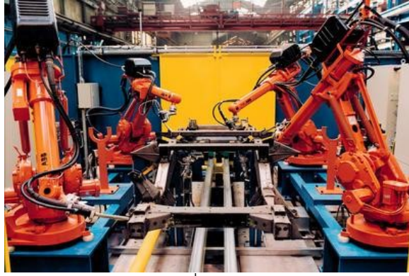
รูปที่ 3.3 ส่วนของเฟรมรถยนต์ทำการเชื่อมอาร์ก (Arc Welding) ด้วยหุ่นยนต์ [10]
