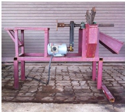
ภาพผนวกที่ 1 เครื่องย่อยต้นมันและใบสำปะหลัง
