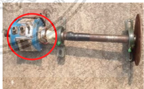
ภาพที่ 3.7 ติดตั้ง Strain gauge บนเพลาชุดสับตัด ภาพที่ 3.8 ติดตั้ง Slip ring บนเพลาชุดสับตัด
