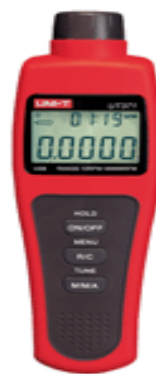
ภาพผนวกที่ 2 เครื่องวัดรอบความเร็วมอเตอร์
