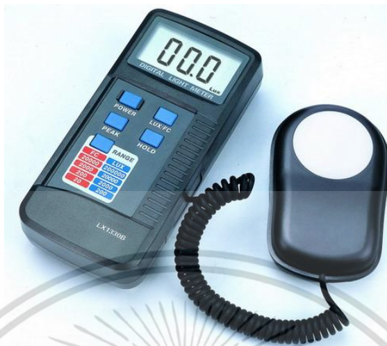
รูปที่ 1 ตัวอย่างเครื่องมือวัดแสง
