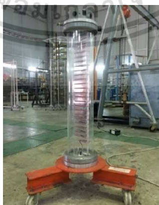
รูปที่ 4.6 โวลเตจดีไวเดอร์ พิกัด 100 kV
