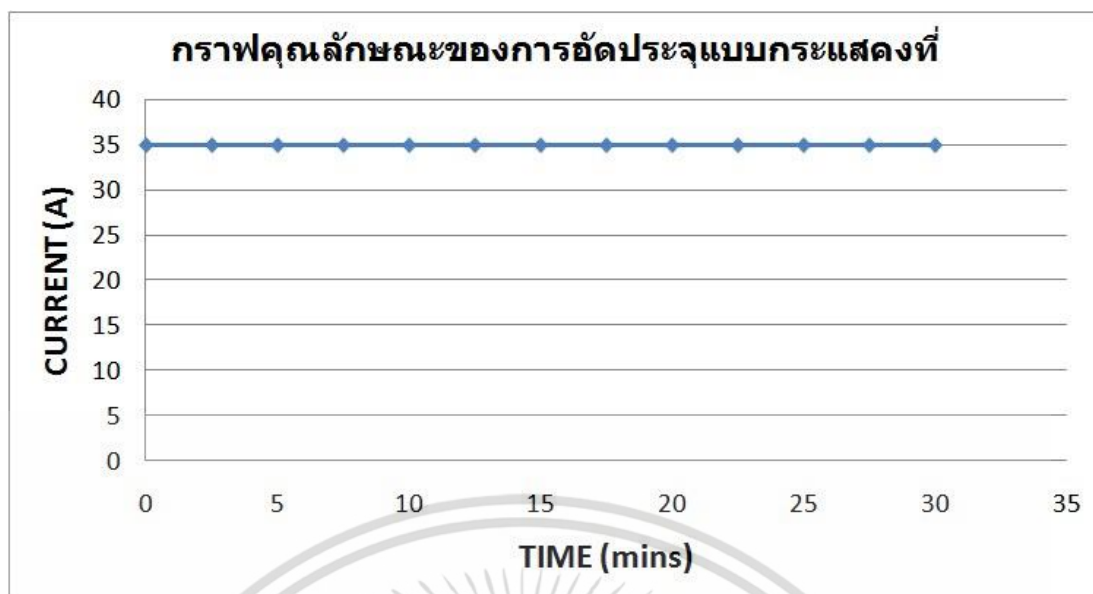
รูปที่ 2.5 คุณลักษณะของการอัดประจุแบบกระแสไฟฟ้าคงที่
