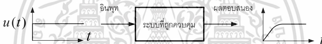
รูปที่ ข.1 การทดสอบระบบที่ถูกควบคุมโดยการป้อนสัญญาณอินพุตขั้นบันได
