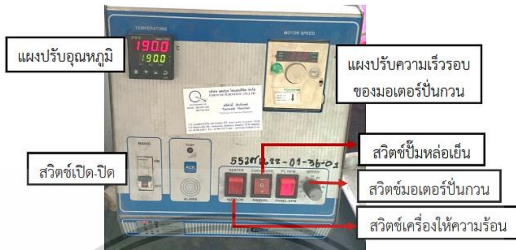
รูปที่ ค.1 แผงควบคุม (controller) ของเครื่องปฏิกรณ์แบบกะ
