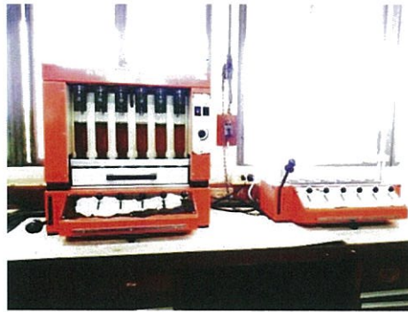
ภาพที่ 2.9 เครื่องวิเคราะห์เยื่อใย (Fibertec System) ยี่ห้อ FOSS รุ่น M6
