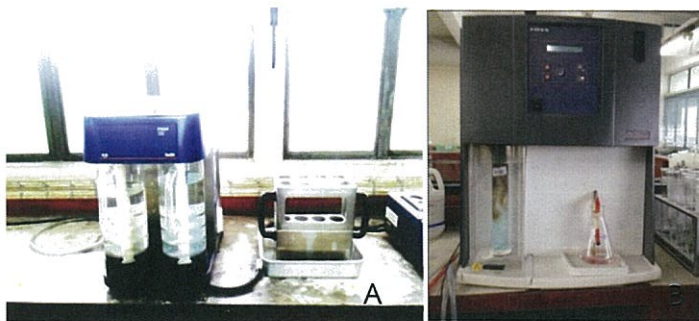
ภาพที่ 2.7 เครื่องดูดจำกัดไอรอด (Scrubber unit) ยี่ห้อ FOSS (A) และเครื่องกลั่นโปรตีน ไนโตรเจน (Distilling unit) ยี่ห้อ FOSS (B)
