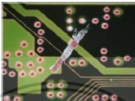
ภาพที่ 4.17 ลายวงจรพิมพ์มีรอยขีดข่วนเสียหาย
