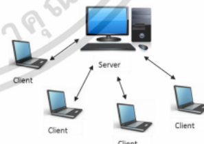
รูปที่ 5 แสดงการทำงานของระบบ Client/Server
