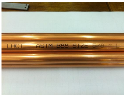
รูปที่ 6.4 ท่อทองแดงชนิด L ตามมาตรฐาน ASTM B88 5/8 นิ้ว
