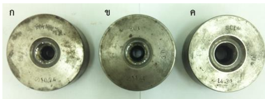
รูปที่ 6.6 ชุดแม่พิมพ์ครึ่งมูแม่พิมพ์ 15 องศา ที่ขนาดการลดลงของพื้นที่หน้าตัดเท่ากับร้อยละ ก) 20 ข) 35 และ ค) 50
