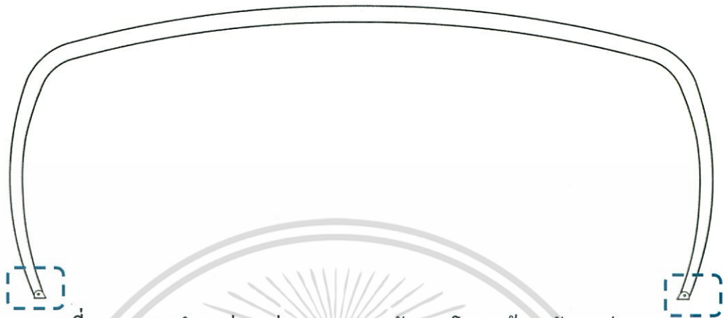
ภาพที่ 4.52 แสดงตำแหน่งจุดต่อและฐานรองรับของ โครงสร้างหลังคารูปแบบ S-02
