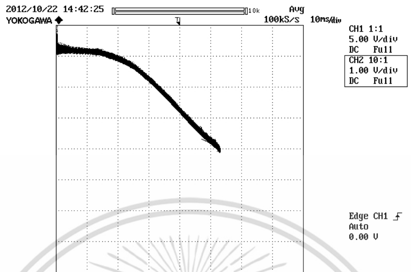
รูปที่ 5.33 ผลการทดสอบกระแสไฟฟ้า I-V characteristic จากวงจรจำลองสัญญาณเลียนแบบ คุณลักษณะทางไฟฟ้าแบบอนุกรม ที่ความเข้มแสง 1,500 \text{ W/m}^2 CH1 : 5 V/div และ CH2 : 1 A/div
