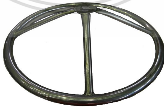
รูปที่ 3.2 อิเล็กโทรดแบบวงแหวนของหม้อแปลงเตสลาแบบโซลิตสเตท
