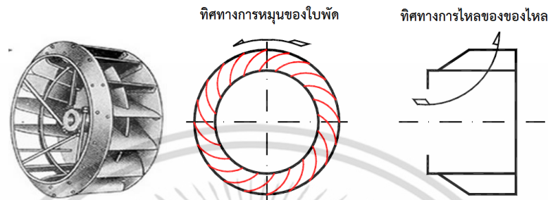
รูปที่ 2.18 ลักษณะและหลักการทำงานของพัดลมภาระจำกัด (กรมพัฒนาพลังงานทดแทนและอนุรักษ์พลังงาน กระทรวงพลังงาน. 2553)
