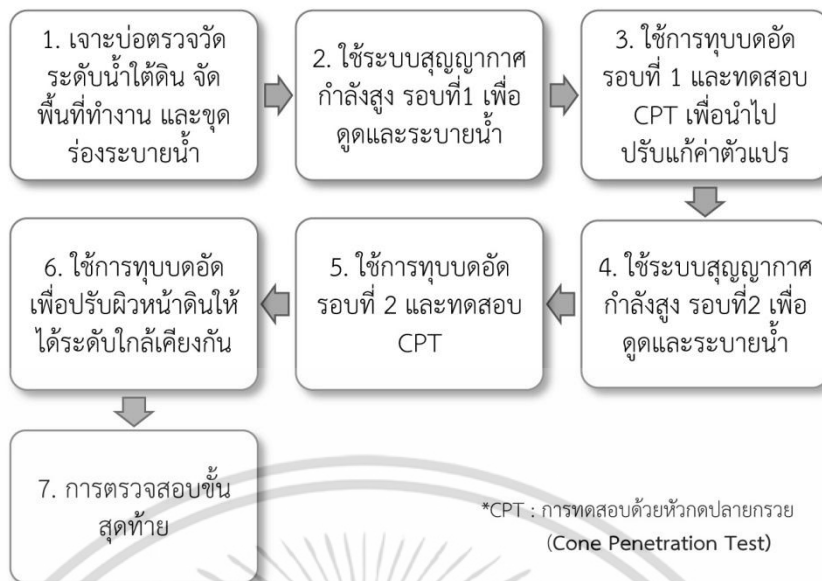
รูปที่ 2.4 ผังงานปรับปรุงคุณภาพดินโดยHVDM (Liang and Xu. 2010)
