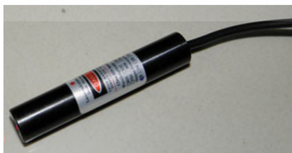
รูปที่ 4.4 แหล่งกำเนิดแสงเลเซอร์ไดโอดแบบเส้นที่ใช้ในงานวิจัย
