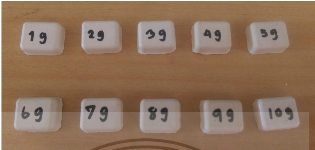
รูปที่ 4.6 แสดงแพนทอม 10 ชั้นที่มีปริมาณแคลเซียมแตกต่างกัน
