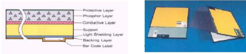
รูปที่ 2.13 แสดงโครงสร้างและลักษณะของอิมเมจเพลต
