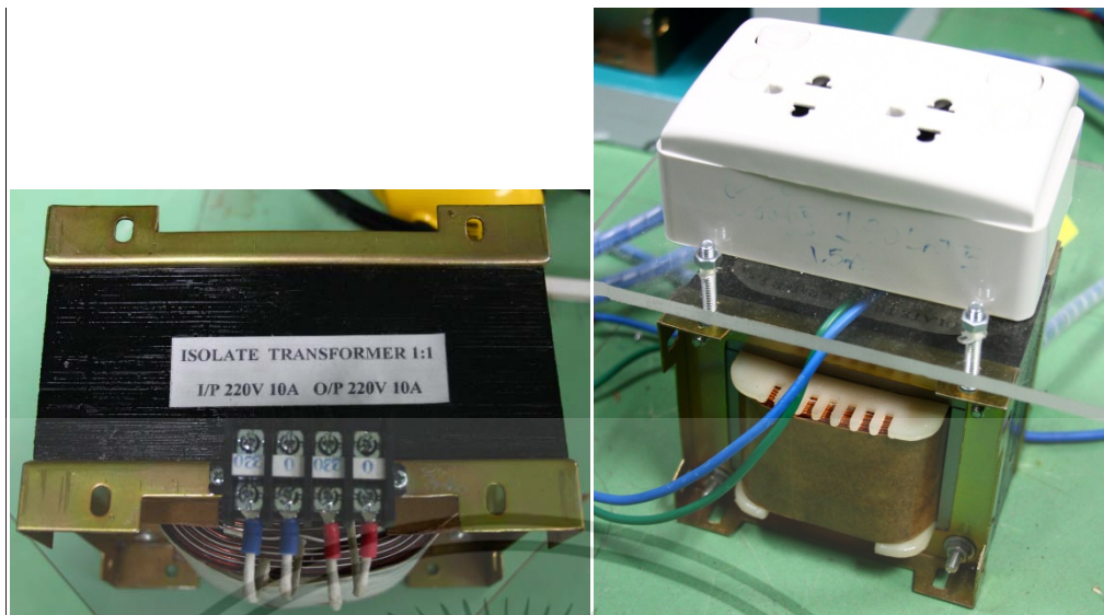
รูปที่ 15 หม้อแปลง Isolate
