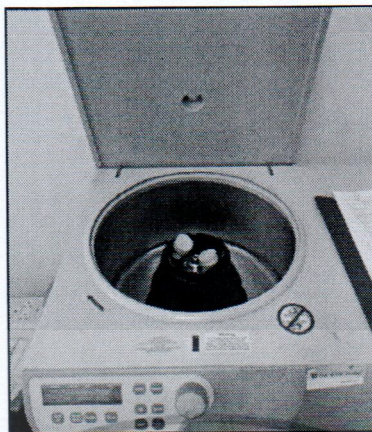
รูปที่ 3.3 เครื่อง Ultra-centrifuge สำหรับการปั่นเหวี่ยงเร่งการตกตะกอน
