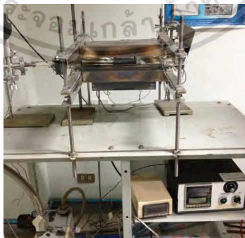
รูปที่ 3.2 แสดงระบบการเตรียมฟิล์มบางโดยวิธีระเหิดสารเคมีด้วยความร้อนในระยะประชิดภายในระบบสุญญากาศ
