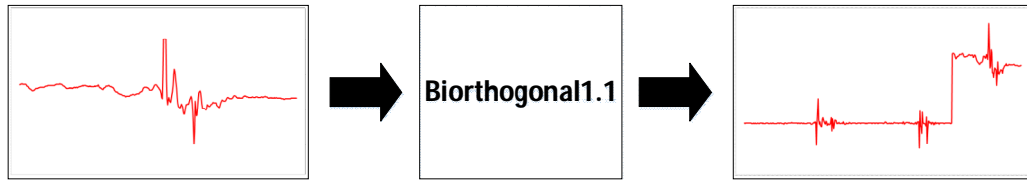
รูปที่ 3.31 ลักษณะสัญญาณความเร่งแกน X จากการหกล้มไปด้านหลังใช้การแปลงเวฟเลต Biorthogonal1.1 ระดับที่ 2
